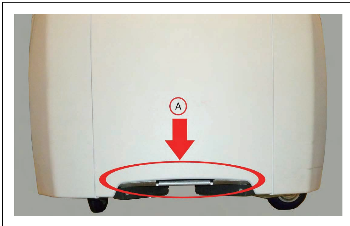
图 8-3. 电池盖底部。（A）在此处提起
