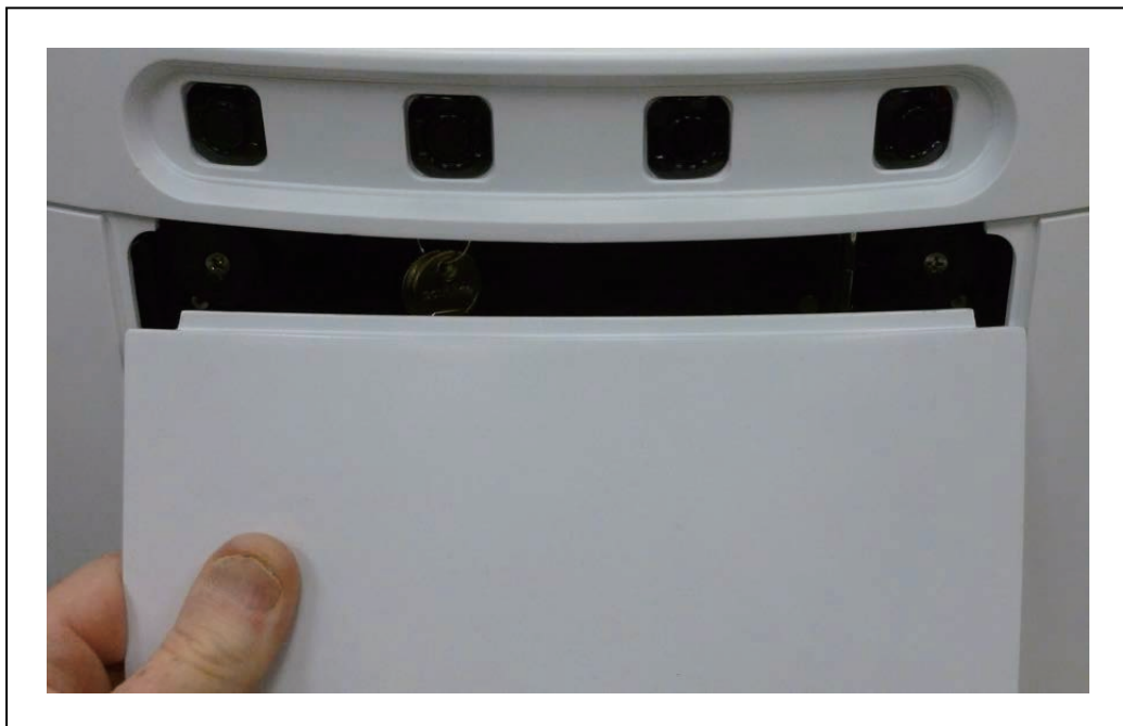
图 3-15. 取下机器人车体电池盖
