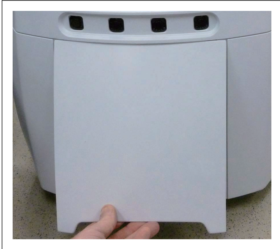
图 3-14. 将机器人车体后盖的底部拉出
