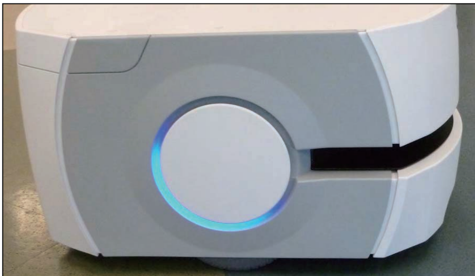
图 8-22. 右侧外壳（边缘处间隙同等）
