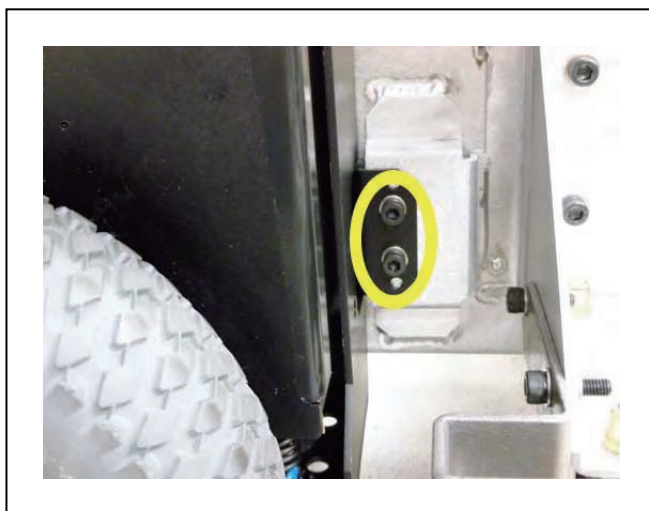
图 8-16. 驱动总成右下角的安装螺丝
