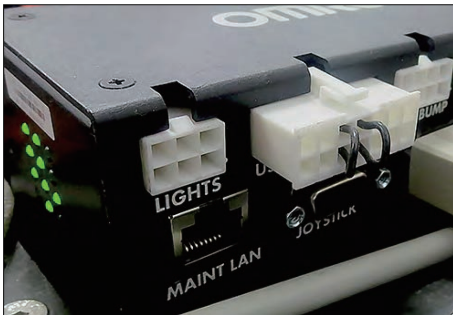
图 3-19. LD 机器人车体控制器上的紧急停止跳线
